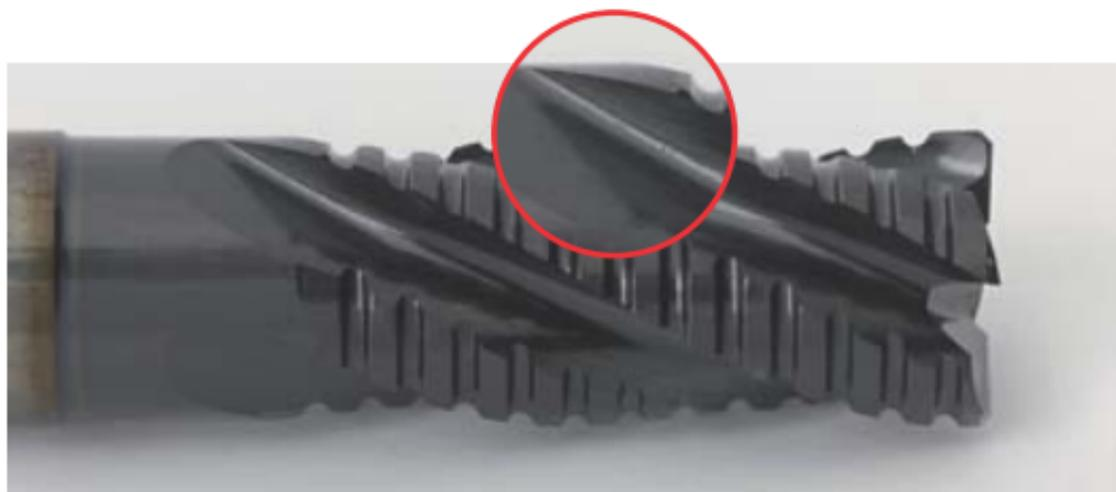
Dentatura piatta di semifinitura: produce trucioli corti e qualità di finitura di superficie superiore e più liscia, rispetto ai tipi NR o NRf. Adatta per fresare materiali normali, fino a ca. 1600 N/mm<sup>2</sup> di resistenza.
