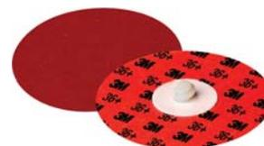
Disco abrasivo **Cubitron II™ 984F - Sistema Roloc™** con abrasivo PSG con granuli a forma triangolare, con additivo per ridurre le temperature in levigatura e proteggere le leghe sensibili al calore come acciaio inossidabile, leghe di nichel e di titanio, velocità di taglio elevate anche a bassa pressione. Compatibile con altri sistemi presenti sul mercato.
