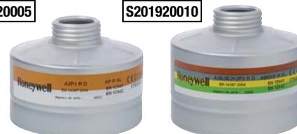
Filtro in alluminio con raccordo RD 40 per maschere pieno facciale monofiltro cod. S20188, bassa resistenza respiratoria, confezionato singolarmente con due tappi ermetici per uno stoccaggio sicuro. Conforme alla norma **EN 14387:2004+A1:2008**.
