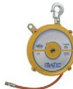
Bilanciatore per utensili pneumatici, **con tubo di alimentazione dell'utensile che funge anche da cavo di sostegno**, corpo in materiale composito, corsa del tubo regolabile, compatto e resistente per cicli di lavoro particolarmente gravosi, la tensione della molla si regola con chiave in dotazione.
