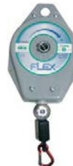
Bilanciatore per utensili, corpo in metallo, per cicli di lavoro particolarmente gravosi, regolazione della coppia della molla con chiave in dotazione, regolazione della corsa della fune mediante morsetto di registrazione, dotato di dispositivo di sicurezza contro la rottura della molla.
