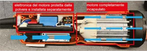
elettronica del motore protetta dalla polvere e installata separatamente
