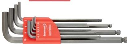
**N20125** - Serie di chiavi maschio esagonali piegate **lunghe** a testa sferica, in acciaio al cromo vanadio, ISO 2936 L DIN 911 L, lato lungo con testa sferica, lato corto con estremità piana e smussata, esecuzione nichelata. La testa sferica permette di operare con inclinazione fino a 30°.
