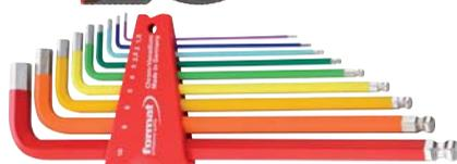
**N20126** - Serie di chiavi maschio esagonali piegate **lunghe** a testa sferica, in acciaio al cromo vanadio, ISO 2936 L DIN 911 L, lato lungo con testa sferica, lato corto con estremità piana e smussata, esecuzione nichelata. La testa sferica permette di operare con inclinazione fino a 25°.
