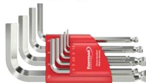
**N20858** - Serie di chiavi maschio esagonali piegate **lunghe** a testa sferica, in acciaio al cromo vanadio, ISO 2936 L DIN 911 L, lato lungo con testa sferica, lato corto con estremità piana e smussata, **esecuzione sabbata**. La testa sferica permette di operare con inclinazione fino a 30°.
