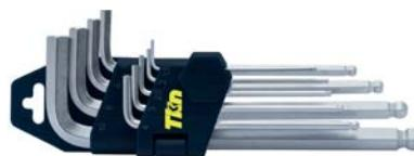
**N20123** - Serie di chiavi maschio esagonali piegate **corte** a testa sferica, in acciaio al cromo vanadio, ISO 2936 DIN 911, lato lungo con testa sferica, lato corto con estremità piana e smussata, esecuzione nichelata. La testa sferica permette di operare con inclinazione fino a 30°.
