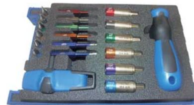
Assortimento di giravite dinamometrico con inserti, per la sostituzione degli inserti da taglio che utilizzano viti con impronta Torx® e Torx Plus®. Il corretto serraggio degli inserti da taglio previene il danneggiamento della vite e garantisce una maggiore durata dell'inserto da taglio, per questi motivi si raccomanda di serrare le viti con un giravite dinamometrico.
