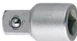
**N10040** - Raccordo aumentatore attacco 1/4" ISO 3316 DIN 3123, con **quadro maschio aumentatore da 3/8"**, in acciaio al cromo vanadio, esecuzione cromata lucida.
