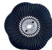
Platorello per l'uso dei dischi in feltro Combiclick® su smerigliatrici angolari. La geometria dei canali di raffreddamento permette un costante passaggio di aria che minimizza l'effetto di riscaldamento dell'utensile e del pezzo. Le ridotte temperature di contatto, l'ottimo sistema di bloccaggio e la stabilità del platorello permettono di ottimizzare il processo di lucidatura.
