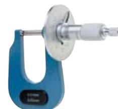
Micrometro con lettura su disco, superfici di contatto in metallo duro, struttura in acciaio con guancialini isolanti, parti di lettura cromate opache, regolazione della forza di misurazione mediante frizione a cricchetto sul codolo, precisione secondo norma interna. Per la misurazione dello spessore di fogli e strisce.
