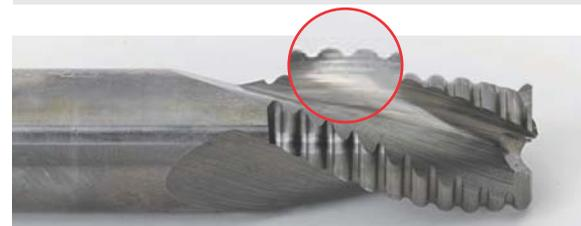
**Tipo WR** Dentatura grossa di sgrossatura, produce trucioli corti e di facile evacuazione. Adatta per fresare alluminio e metalli non ferrosi, nonché acciai con resistenza < 600 N/mm<sup>2</sup>.
