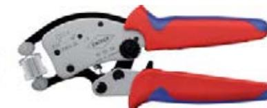
Pinze crimpatrici per terminali a bussola DIN 46228/1 e 4, isolati e non, **modello con testa di crimpatura girevole a 360°**, 8 posizioni di innesto per il serraggio in tutte le posizioni di lavoro, regolazione automatica alla dimensione desiderata del terminale a bussola, precisione sicura e duratura grazie al blocco forzato e sbloccabile, trasmissione a leva articolata per la riduzione dello sforzo, in acciaio al cromo vanadio temprato a olio, impugnature ergonomiche bimalteriali.
