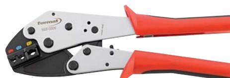
Pinze per capicorda preisolati, **modello a cremagliera con innesto laterale** e riapertura automatica delle ganasce a compressione ultimata, con vite di registrazione della pressione predefinita, corpo in lamiera d'acciaio, esecuzione cromata opaca, ganasce in acciaio microfuso, impugnature in plastica.
