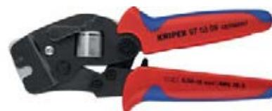
Pinze crimpatrici per terminali a bussola DIN 46228/1 e 4, isolati e non, **modello con innesto frontale**, con matrice a profilo quadrato, regolazione automatica alla dimensione desiderata del terminale a bussola, precisione sicura e duratura grazie al blocco forzato e sbloccabile, trasmissione a leva articolata per la riduzione dello sforzo, in acciaio al cromo vanadio temprato a olio, esecuzione brunita, impugnature ergonomiche bimalteriali.
