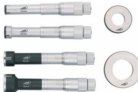
Set di micrometri analogici per interni a 3 punte con superfici di contatto in acciaio temperato fino al  $\varnothing$  12 mm, oltre contatto in metallo duro, nonio cromato satinato, regolazione forza di misura mediante nottolino a frizione, per fori passanti dal  $\varnothing$  12 mm anche per fori ciechi, precisione secondo norma DIN 863/4.
