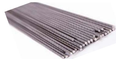
Bacchetta Fro SF **AWS A5.2-92: R45** in acciaio al carbonio per la saldatura autogena di acciai al carbonio non legati; indicato per tubi, serbatoi e costruzioni saldate. Punto medio di fusione: 1530 °C.
