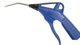
Pistola di soffiaggio (serie 208) con valvola che la rende idonea all'utilizzo sia con aria che con fluidi non infiammabili. **Tubo Star-Tip a 6 uscite separate che rende la pistola silenziosa e conforme ai requisiti sulla sicurezza OSHA.** Materiale: tecnopolimero POM (struttura), ottone (valvola, tubo); guarnizione: NBR (gomma nitrile); temperatura di utilizzo: -20 °C +60 °C.
