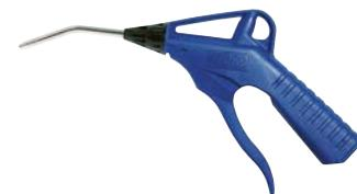
Pistola di soffiaggio (serie 208) con valvola che la rende idonea all'utilizzo sia con aria che con fluidi non infiammabili. Sono disponibili numerosi tubi e punte per soddisfare specifiche applicazioni. Materiale: tecnopolimero POM (struttura), ottone (valvola, tubo); guarnizione: NBR (gomma nitrile); temperatura di utilizzo: -20 °C +60 °C.
